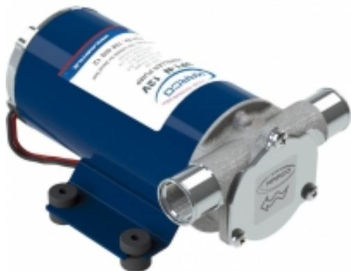
Elettropompa autoadescante dotata di girante speciale per servizi prolungati. Adatta per acqua dolce e salata per uso intermittente. Porta spazzole con calotta impermeabile e passacavo stagno. La pompa può essere utilizzata con il tubo esterno incrementando la portata di 3 l/min. Applicazioni principali: pompa di sentina, acque grigie.
