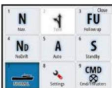
Per cambiare il profilo di lavoro utilizzando il MFD, l'autopilota deve essere in modalità standby.
